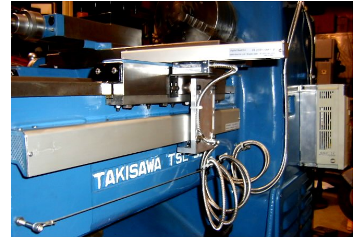
×軸・Z軸の取り付け図 ケーブル保護の為 下部にサポートワイヤー取り付け
